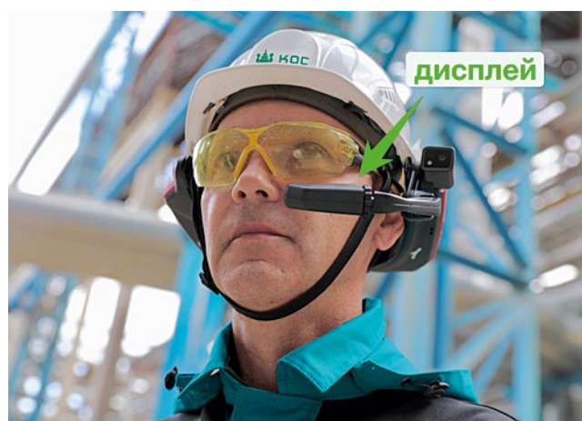
Мы работаем с монокулярными AR-очками в разных исполнениях: пылевлагозащита или взрывобезопасные
