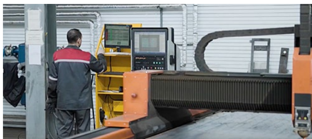
Терминалы на участках позволяют работникам самим, без участия мастера брать работу и закрывать задания при помощи сканеров QR-кода
