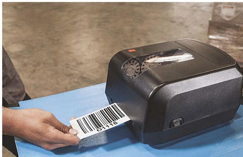
Для изготовления маркировки используется термотрансферный принтер печати этикеток
