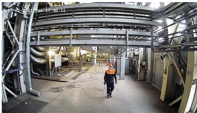
«Машинное зрение» помогает определить соблюдение нормативов по использованию спецодежды, СИЗ, контролирует опасные зоны на производстве.
