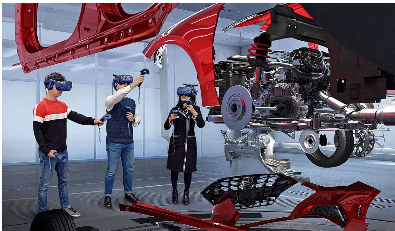
VR-система анализа конструкторских решений Hyundai поддерживает до 20 пользователей одновременно и позволяет проводить виртуальные испытания в различных моделируемых ситуациях.
