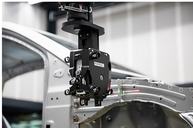
Лазерный 3D-сканер производства, установленный на робота, работает в комплексе с лазерным трекером. Фото: «Хендэ Мотор Мануфактуринг Рус»
