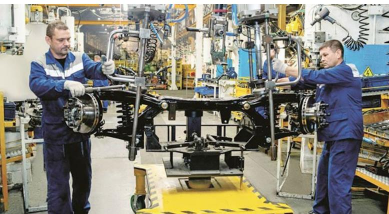
На участке ступельной сборки передней подвески «Газели NEXT» в ЗМА работает поток из пяти роботизированных тягачей
