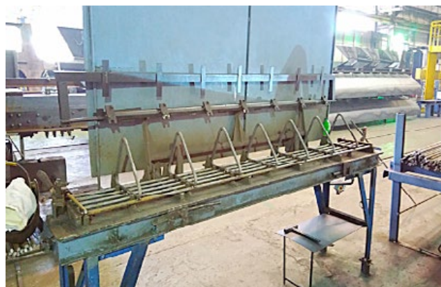
Рис. 3. Участок сварки вагона-хоппера (до кайдзен–после кайдзен): увеличенная прижимная планка обеспечивает плотное прижатие кронштейнов без смещения
