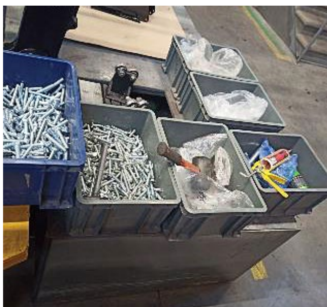
Рис. 3. Участок сборки и монтажа (до–после): сокращение времени на поиск крепежа, улучшение условий труда
