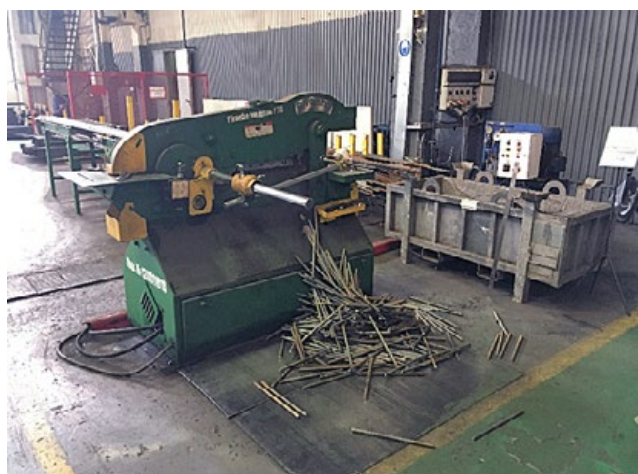
Рис. 2. Участок обработки проката (до кайдзен–после кайдзен): поставка с тарой не позволяет деталям падать на пол
