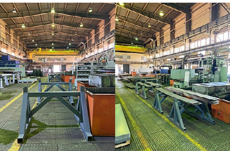
Цех №2/11. Применение подставок для хранения крупногабаритных деталей на заготовительном участке
