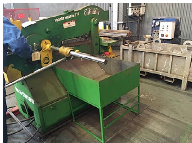
Рис. 2. Участок обработки проката (до кайдзен–после кайдзен): поставка с тарой не позволяет деталям падать на пол
