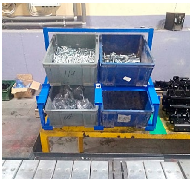
Рис. 3. Участок сборки и монтажа (до–после): сокращение времени на поиск крепежа, улучшение условий труда
